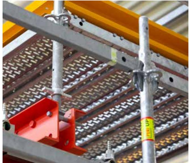
**Die Verbindung zwischen dem PERI UP Gerüstbaukasten und dem VARIOKIT Ingenieurbaukasten erfolgt aufgrund des metrischen Rasters beider Systeme spielend einfach und dank der Passbolzen kupplungsfrei. Auch ein Zusammenschweißen der Stahlriegel ist aufgrund der auf die Systeme abgestimmten Verbindungselemente nicht notwendig.**
