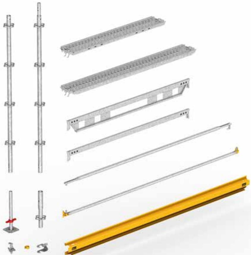
Auch die standardmäßig in allen Gerüstbelägen, Leitgangtafeln und Durchstiegbelägen integrierte Abhebesicherung „Locking Deck“ macht das Handling einfach, da eine zusätzliche Sicherung von oben komplett entfällt. Locking Deck bewirkt, dass die Beläge nach dem Abfallen den Riegel untergreifen und sofort gesichert sind. Sie lassen sich sogar nachträglich schnell von unten ausbauen, wenn beispielsweise einzelne Felder geöffnet werden müssen.
